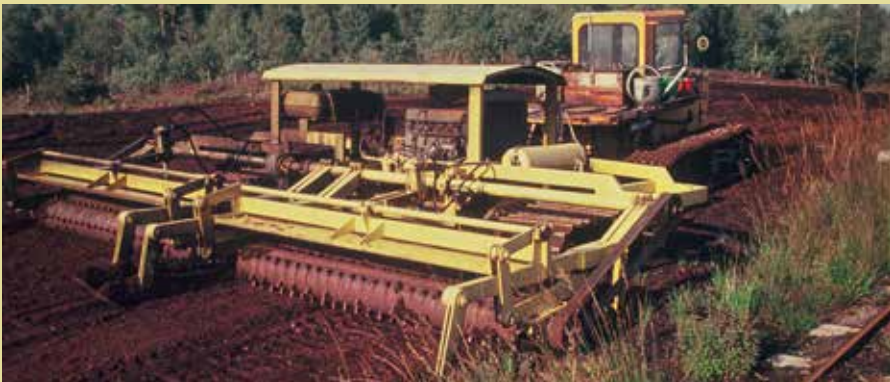
Mit riesigen Maschinen wird heute noch in einigen Ländern Torf in großen Mengen vor allem als Brennmaterial z.B. für Kraftwerke gewonnen. Moorleichen werden dabei nicht mehr entdeckt. (KG)
